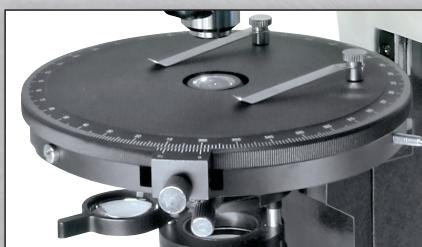
360° drehbarer Objektivtisch mit Grad-einteilung, 1° Schritte mit Nonius
