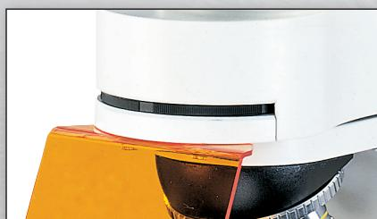
Drehbare Filterscheibe mit Anregungsfilter
